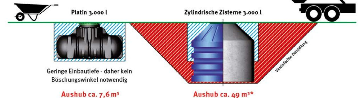
\* Ausgehend von einer stehenden, zylindrischen Zisterne mit Nutzvolumen 3.000 Liter, einer Höhe von 1,90 m und einem Durchmesser von 2,20 m. Berechnung des Aushubs unter Berücksichtigung einer Grubensohle von 10 cm, einem seitlichen Arbeitsraum von 50 cm sowie einer Böschung mit 45° Neigung gemäß DIN 4124.
