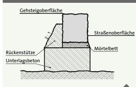
Regelquerschnitt Randeinfassung auf geschalttem Unterlagsbeton
