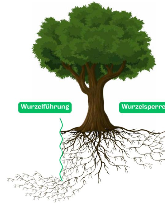
Wurzelführung wird empfohlen, wenn ein Schirm **innerhalb von 2 Metern** von der Baumwurzel platziert werden muss. Wurzelführung ist mit **vertikalen Rippen** versehen, die zudem auch als Erdverankerung funktionieren. Außerdem sorgen diese Führungsrippen dafür, dass Baumwurzeln nach unten geführt werden, um einen "Blumentopfeffekt" zu vermeiden.
