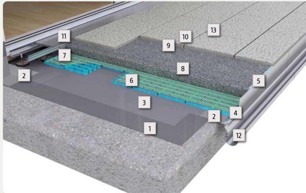
1. DiProtec® SDB Schnelldichtbahn oder ARDEX 8+9/9 L Dichtmasse und Dichtkleber
