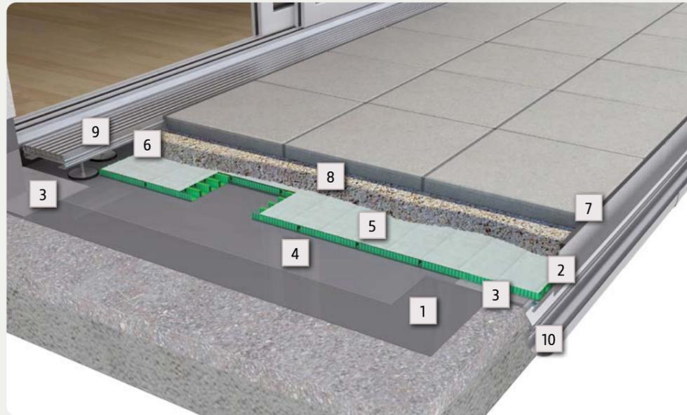
1. DiProtec® SDB Schnelldichtbahn oder ARDEX 8+9/9 L Dichtmasse und Dichtkleber
