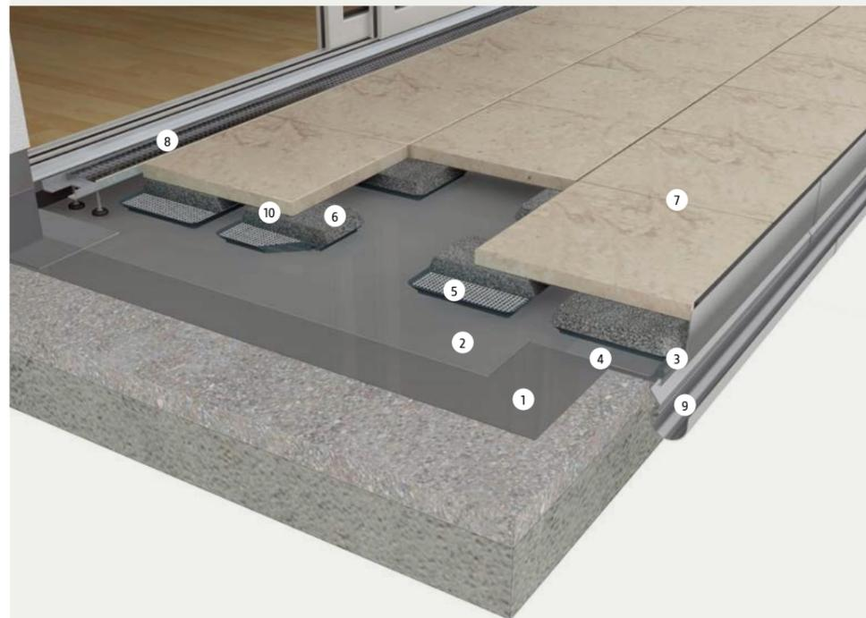
1. DiProtec® SDB Schnelldichtbahn oder ARDEX 8+9/9 L Dichtmasse und Dichtkleber
